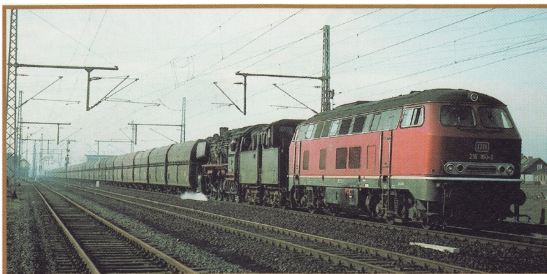
Ci-dessus, une descendante de la V-200, une V-216, dans une curieuse composition en double traction avec une locomotive à vapeur
